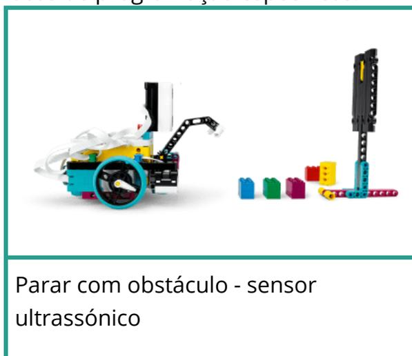
Um primeiro exemplo de um robô móvel interativo poderia envolver a incorporação de um sensor ultrassónico, capaz de detetar a presença e a distância de um obstáculo. Isto pode levar à geração de código que instrui o robô a realizar um movimento específico com base na condição de presença do obstáculo. Tipicamente, o robô começaria a mover-se e só pararia quando o sensor detetasse a presença de um obstáculo mais próximo do que um limite especificado.
